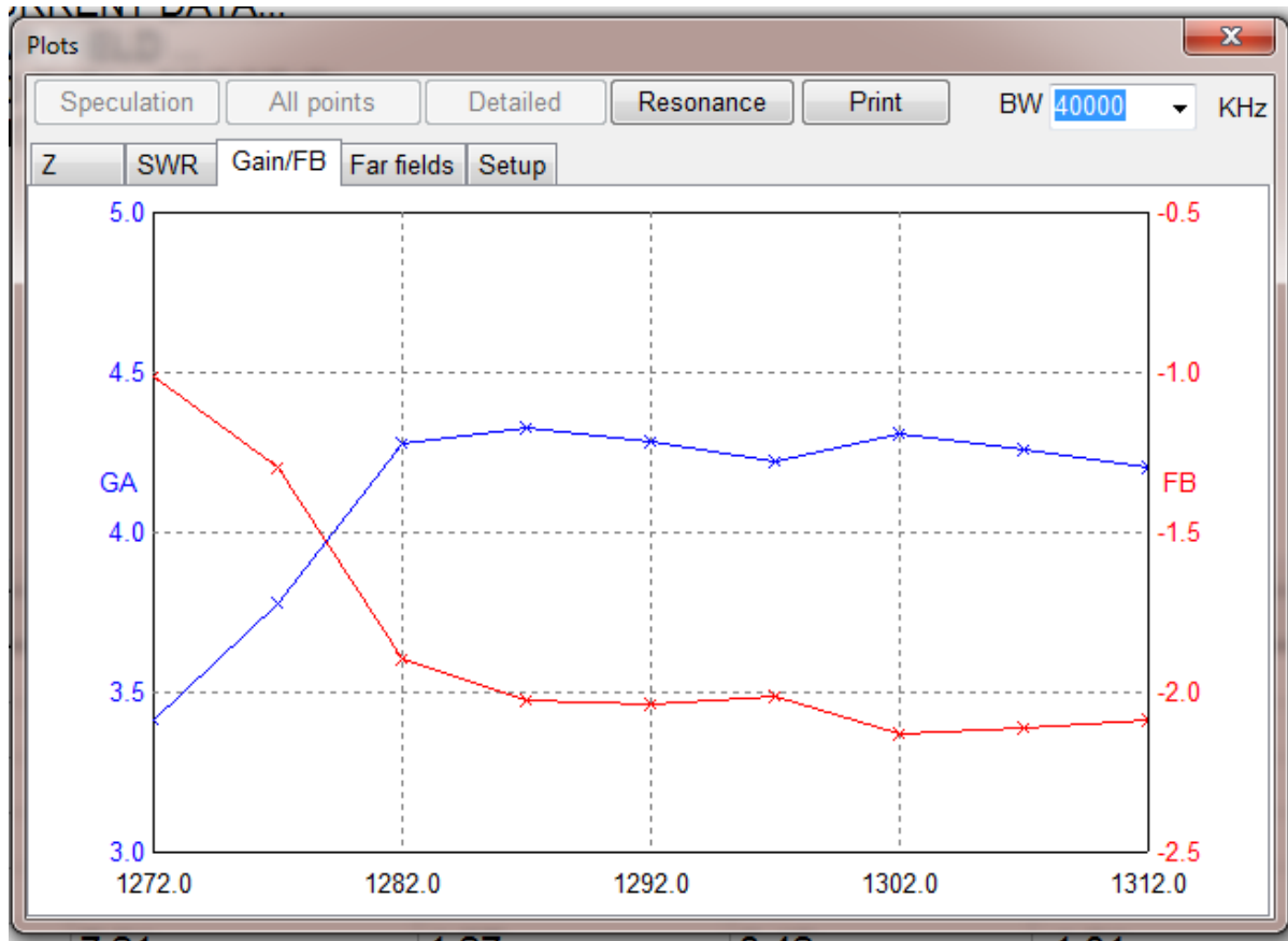
სურ.3.2.10 ანტენის გაძლიერების კოეფიციენტის დამოკიდებულება სიხშირეზე.
